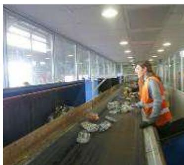
**2.** Ils sont ensuite dirigés sur un tapis de tri où une machine et/ou un opérateur réalise le tri des matériaux
